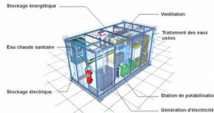
Pour la gestion des eaux usées, il est privilégié la connexion au réseau d'assainissement public. Dans l'impossibilité de cette solution, l'installation d'une micro-centrale d'épuration assure l'autonomie.
